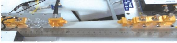
图5 662 GHz 雷达相位稳定度测试场景
