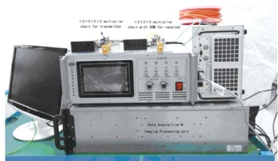
图 1 662 GHz 雷达实验平台集成实物图
